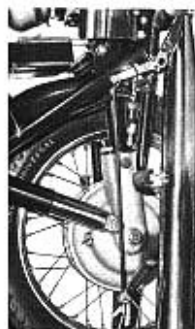
後輪を駆動するシャフト・ドライブシステム
