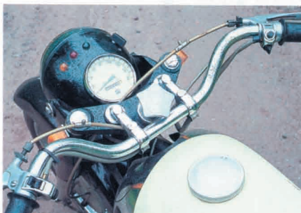
MODERNA TIDER. Hastighetsmätaren med vit botten och de fina reglagen på tumavstånd ger ett modernt intryck. Alla originaldetaljer är intakta. Till och med de ursprungliga vajrarna med smörjpipor finns kvar.
